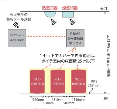
VEC-100ESN II × 3 基で機器の間 500mm の場合、 幅 (本体幅 1.31m+ 機器の間 0.5m+1.31m+0.5m+1.31m)× 奥行 2.151m =設置面積 約 10.6 ㎡
